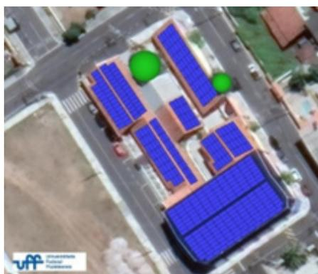
Fig. 79 - Configuração do sistema
