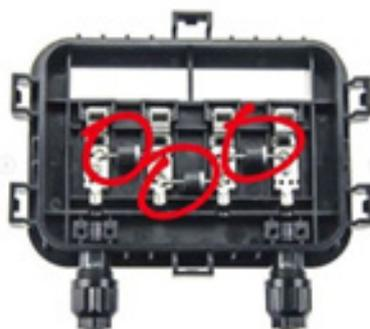
Figura 4 - Modelo de caixa de junção com os diodos de bypass (em vermelho).
